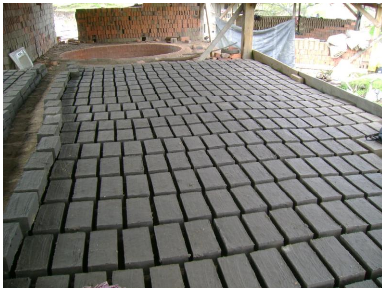
Fotografía 4: Secado de panelones previo al raspado
