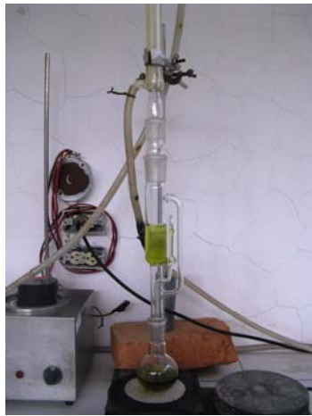
Fotografía 8: Extractor con la muestra para obtener % de grasas.
